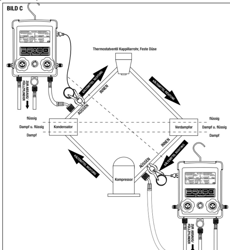
**Die Überhitzung**, ist der Unterschied zwischen der tatsächlichen Temperatur (**Sensortemperatur**) des Kältemittels (Gas) beim Verlassen des Verdampfers und der Siedepunkttemperatur (**Sattdampftemperatur**) des Kältemittels in den Verdampferspirale. Wenn der Siedepunkt erreicht ist, setzt sich die Aufwärmung des Kühlmittels fort.
