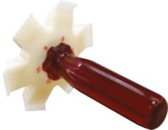
Limpa e desentorta aletas de condensador e evaporador. Cabeçote com seis faces para aplicações com 8, 9, 10, 12, 14 e 15 aletas por polegada.
