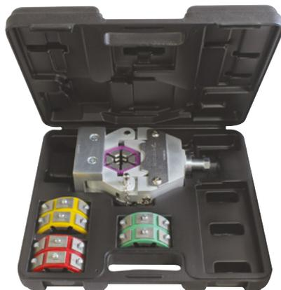
O 71550 é o nosso crimpador de mangueira A/C de "estilo manual". Os moldes rapidamente no encaixe, sem a necessidade de pinos e parafusos. a unidade pode ser facilmente montada em uma bancada usando o dispositivo de suporte, ou presa a um vise. Este kit vem com um conjunto completo de moldes, para os tamanhos de mangueira: #6, #8, #10 e #12. **PATENTE Nº 6.324.884 \* Também há disponibilidade de tamanhos para barreira reduzida.**
