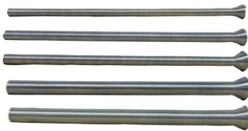
Ferramentas econômicas e eficazes para dobrar tubulação de cobre maleável ou alumínio sem riscos. O aço mola níquelado é alargado em uma extremidade para inserção rápida do tubo. Cada ferramenta dobra um lado.
