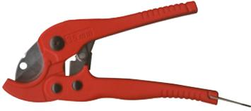
A ação da catraca torna este cortador extremamente fácil de operar, resultando em cortes rápidos e precisos. A lâmina de corte é feita de aço com liga especial com tratamento térmico para garantir longa durabilidade. Corta todas as mangueiras de borracha e tubos de PVC de até 1 ½" (38 mm) D.E. (Não recomendado para PVC200)
