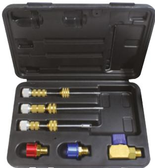
A ferramenta perfeita para substituir núcleos de válvulas danificados com refrigerante R1234yf no sistema sem perder a carga do sistema.
