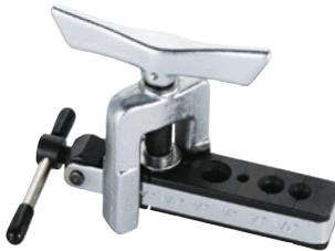
Ferramenta de Alargar Padrão de 45° com Bloco de Molde Corrediço, alarga e faz o polimento de 6 tamanhos: tubos com D.E. de 3/16, ¼, 5/16, 3/8, ½ e 5/8.
