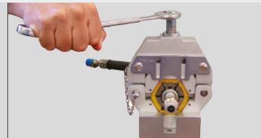
Halterung schließen, Stift einstecken und Dornschraube drehen
