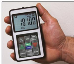
Wenn die Tastatur außerhalb der Bereichs ist, geht das Gerät automatisch in Pause. Diese Pause-Mechanismus ermöglicht die Waage neu zu starten, wenn den Abstand wieder in Bereich ist.
