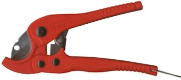
Die ratschenbewegung erlaubt einen leichten sauberen und schnellen schnitt. Das schneidmesser ist aus spezial gehärteter metallegierung und sehr widerstandsfähig. Schneidet schläuche aller art. und PVC rohre bis 1/2" O.D. (Nicht empfohlen für PVC200).
