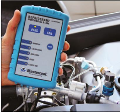
Der Kältemittel-Analysator hilft die Präsenz und die Qualität des R134a Kältemittels in Fahrzeug-Klimasystemen zu bestätigen.
