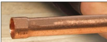
Die Hydra-Swage erweitert mit hydraulischem Druck Kupfer, Aluminium und weichen Stahl. **PATENT Nr. 6,619,099**
