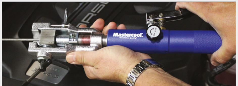
Dieses Set enthält Teile zum Herstellen von 1/4, 5/16 und 3/8" Rohre, GM Brennstoffrohrbördeln in folgenden Maßen, 5/16 und 3/8"; Bördeln/ Doppelbördeln, 3/16, 1/4, 5/16, 3/8 und 1/2" metrisches „Bubble“ bördelanschlüsse in Maßen 4,75, 6, 8 und 10mm. Dieser Satz wird in einem stabilen Kunststoffkoffer geliefert. **PATENT Nr. 5,782,128**
