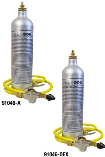
Umfasst Sprühpistole, Dose und Dosenadapter. Entwickelt, um mit jeglichen leichten Spülmittel zu arbeiten, die mit Druckluft gemischt werden können. Hervorragend zur schnellen und effektiven Entfernung von Kältemittelrückständen während des Umrüstens oder dem Kompressoraustausch.
