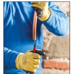
**DAS EINZIGE EXZENTRISCHES BÖRDELGERÄT AUF DEM MARKT ZUR DECKUNG VON BIS ZU 7/8"**
