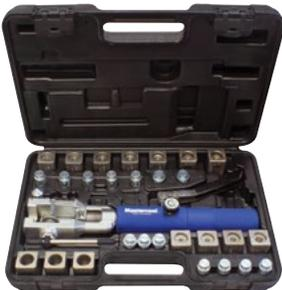
Ce kit évase en dimensions de: 1/4, 5/16 et 3/8"; Evasement de tube conduite de Fuel sur GM, en 5/16 et 3/8"; Evaseur / double évaseur, 3/16, 1/4, 5/16, 3/8 et 1/2" Evaseur - bulle métrique, 4,75, 6, 8 et 10 mm présentation dans une boîte moulée spéciale en plastique. **No. de Brevet 5,782,128**
