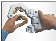
La matrice se place aisément et rapidement dans la presse sans demander ni vis, ni autres moyens de fixation.
