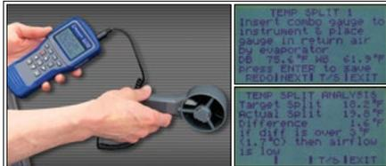
Deux mesures de la sonde indiqueront le split de température ciblé et le split de température actuel à travers l'évaporateur et compareront les deux.
