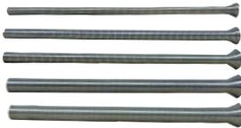
Outil efficace et économique pour cintrage de tubes en cuivre, ou aluminium sans défauts. Une insertion rapide se fait au moyen du ressort en acier plaqué au nickel, évasé à une extrémité. Chaque outil ne sert qu'à une dimension.
