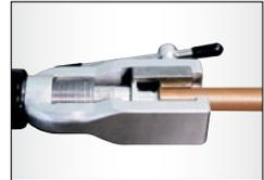
Le tube cuivre est tenu dans l'étrier par les matrices. La presse hydraulique pousse la matrice pour exécuter l'évasement ou l'expansion. Photo: la procédure en cours
