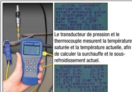
Le transducteur de pression et le thermocouple mesurent la température saturée et la température actuelle, afin de calculer la surchauffe et le sous-refroidissement actuel.
