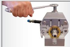
La matrice se place aisément et rapidement dans la presse sans demander ni vis, ni autres moyens de fixation.
