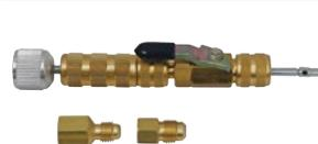
Nouveau design à mécanisme de blocage patenté. Le kit 91498 est le seul outil démonte/remonte noyau de vanne incorporant un écrou de sécurité. Celui-ci permet le technicien d'engager le noyau de vanne sans devoir combattre la Haute Pression. Ce kit comprend le filetage 1/2"-20 UNF (japonais) ainsi qu'un raccord 1/4" SAE. Emballé en boîte en plastique rigide.
