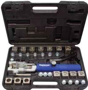
Este juego hace conectores tipo "PUSH" de: 1/4, 5/16 y 3/8"; abocina tubos de conducción de gasolina para GM, 5/16 y 3/8"; abocinado / doble abocinado, 3/16, 1/4, 5/16, 3/8 y 1/2". Abocinado de burbuja métrica, 4.75, 6, 8 y 10 mm y vienen en estuche de transporte. **PATENTE NO. 5,782,128**
