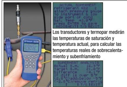
Los transductores y termopar medirán las temperaturas de saturación y temperatura actual, para calcular las temperaturas reales de sobrecalentamiento y subenfriamiento
