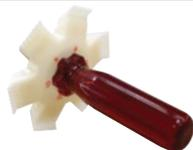
Limpia y endereza las aletas de condensador y evaporizador. Cabeza con seis peines para 8, 9, 10, 12, 14 y 15 aletas por pulgada de aplicación.
