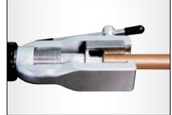
El tubo de cobre es asegurado en la instalación de fijación por la conformación de los dados. La bomba empuja el adaptador hacia adentro para abocinar o expandir. Este recuadro muestra la formación en proceso.
