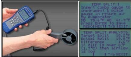
Con sólo dos medidas, el sensor dará la temperatura deseada y la temperatura actual a través del evaporador y comparará las dos.
