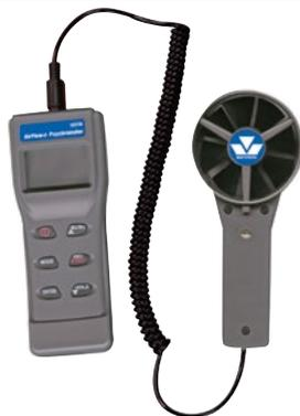
Lee Humedad, Temperatura del aire, Punto de condensación, Gama de humedad interna, Velocidad del Aire, Volumen del Aire y BTU. El sensor está construido en el ventilador y está protegido por una cubierta giratoria.
