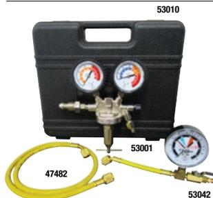
**53010 JUEGO DE REGULADOR PARA PRUEBA DE PRESIÓN (US):** Regulador de la presión de nitrógeno (53001), 48" manguera de carga - amarilla (47482), Adaptador para prueba de fugas (53042), R410a adaptador recto 1/4 FL-M x 5/16 giratorio-F (90413), maletín moldeado (53000-PB)
