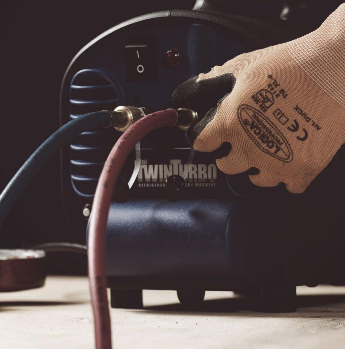
**98310 BALANZA INALÁMBRICA PARA CARGA DE REFRIGERANTES**
