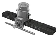
Agregue el 71680 a los sets hidráulicos de Mastercool que Ud. ya tiene. Esto le permitirá hacer abocinado OEM con un simple movimiento de la manilla de la bomba. Abocina 7 tamaños: 1/4, 5/16, 3/8, 1/2, 5/8, 3/4, 7/8."
