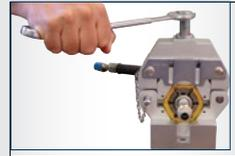
El dado encaja en la instalación de la prensa rápidamente, sin necesidad de clavos o tornillos.
