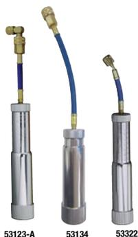
Para inyectar aditivo o aceite, simplemente se conecta el inyector a la baja presión del sistema A/C y girando la empuñadura hasta alcanzar la cantidad deseada.
