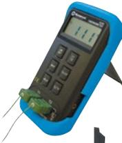
El 52228 termómetro digital diferencial provee la medición de dos puntos simultáneamente. (T1, T2) y T1-T2.
