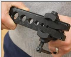
El riel permite que el puente se mueva suavemente mientras el abocinador y la barra se mantengan alineados.
