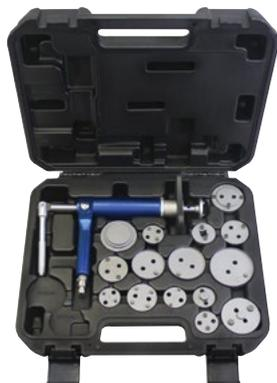
Set neumatico para comprimir el piston del caliper de los frenos construido con aluminio anodizado liviano de larga duracion. Operacion derecho o izquierda para la parte posterior del piston del caliper. La operacion neumatica de un solo piston presiona el eje permitiendo al tecnico realizar su trabajo.
