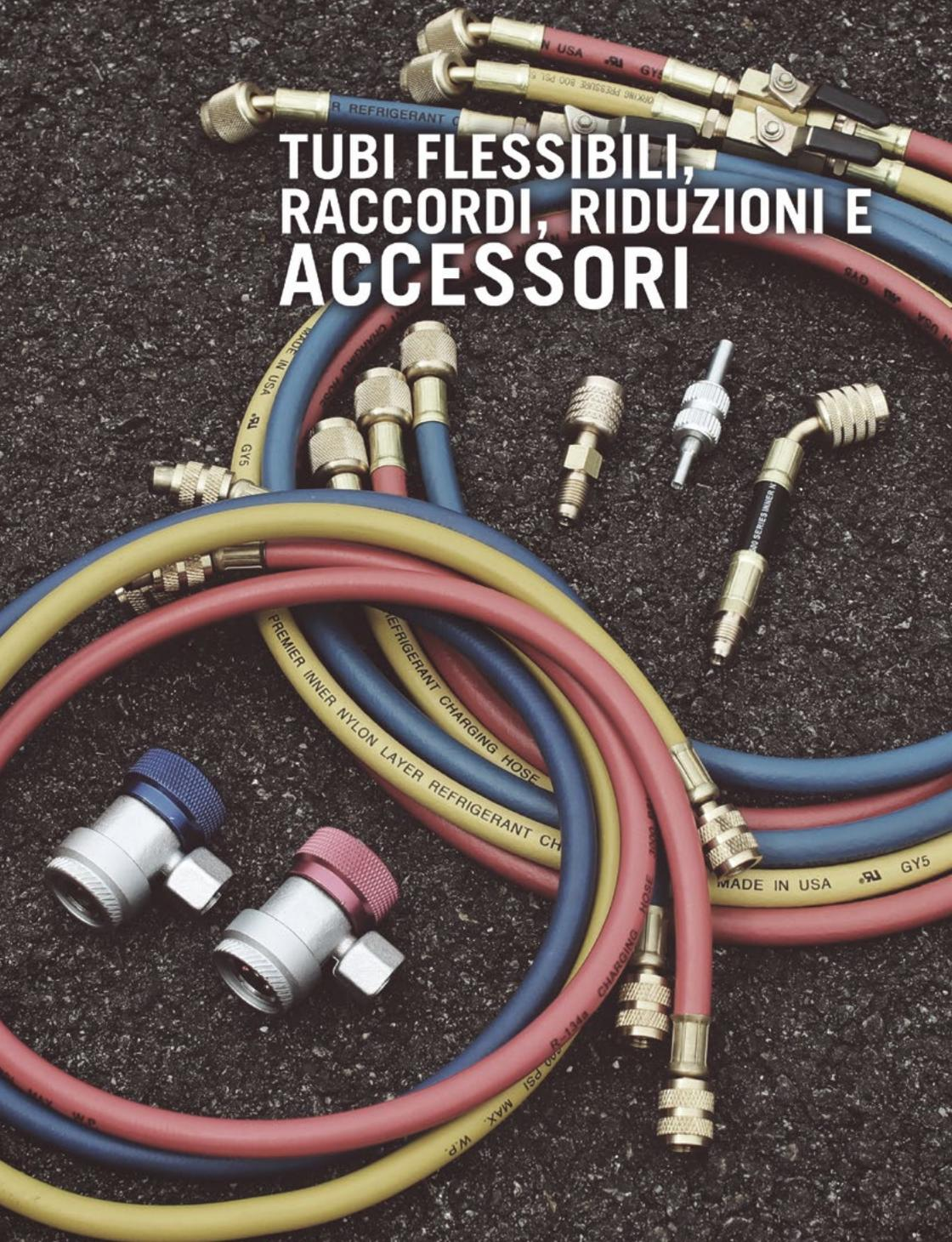
Mastercool usa solo tubi di alte prestazioni, barrier e in nylon, per applicazioni sotto alta pressione. Girelli zigrinati d'ottone facilitano il serraggio con le dita. Aggraffati mediante filiere di 8 segmenti per un attacco sicuro e massima durata. I tubi flessibili sono disponibili in set e lunghezze varie per soddisfare tutti i requisiti di EPA, SAE e UL per il contenimento dei refrigeranti.
