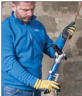
Mastercool introduce questo nuovo prodotto alla sua linea di attrezzi idraulici per tubi. Questo kit e' una versione migliorata del gia' presente sistema "Hydra Swage" e permette all'utilizzatore di eseguire piu facilmente flange e svasature dei tubi in rame. **PATENTE# 6,619,099**
