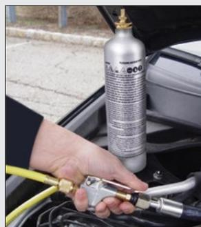
**91046-A** Kit di lavaggio per impianti AC con attacco standard per aria compresso
