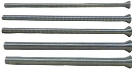
Attrezzatura economica e efficace per la piegatura dei tubi di rame dolce o di alluminio senza schiacciamenti. Placcato in nichel, la molla d'acciaio si fleggia ad un'estremità per un'inserzione di tubi rapida. Ogni attrezzo curva una dimensione.
