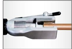
Das Kupferrohr wird durch die Formung in der Betriebs-Vorrichtung gesichert. Die Hydraulikpumpe treibt im Adapter um den Bördel oder die Erweiterung zu fabrizieren. Diese Foto zeigt der Umformung.
