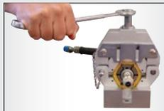
Die Quetschbacken lassen sich einfach in der Halterung stecken und es werden keine Schrauben benötigt.
