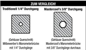
Mastercool's Prüfarmature aus Aluminium sind ausgeführt mit HOCHWERTIGEN KUGELVENTILEN.
