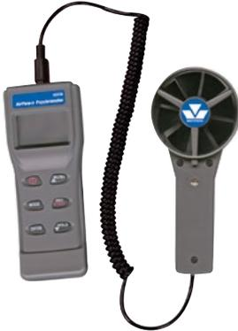
Liest Luftfeuchtigkeit, Lufttemperatur, Taupunkt, Feuchtkugeltemperatur, Luftgeschwindigkeit, Luftvolumen & BTU. Der Sensor ist in dem fernbedienten Ventilator eingebaut und von einer drehbaren Kappe geschützt.
