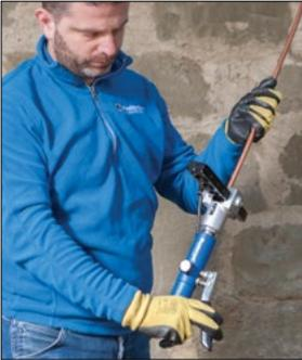
Mastercool stellt das neueste Mitglied seines Handhydraulik Rohrwerkzeuge-Gamma vor. Diese neuen Kits sind ein Upgrade der bestehenden Hydra-Press Aufweitung-Kits, so dass der Benutzer auch leicht OEM Bördeln mit der Pumpe des Griffs machen kann. **PATENT Nr. 6,619,099**
