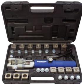
Dieses Set enthält Teile zum Herstellen von 1/4, 5/16 und 3/8" Rohre, GM Brennstoffrohrbördeln in folgenden Maßen, 5/16 und 3/8"; Bördeln/ Doppelbördeln, 3/16, 1/4, 5/16, 3/8 und 1/2" metrisches „Bubble“ bördelan-schlüsse in Maßen 4,75, 6, 8 und 10mm. Dieser Satz wird in einem stabilen Kunststoffkoffer geliefert. **PATENT Nr. 5,782,128**
