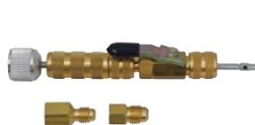
(Geignet für Hochdrucksysteme) – (410A) Ein neu entwickeltes Werkzeug mit Patent-Gewindeführung. Hierdurch ist dieser Ventilschlüssel das einzige Werkzeug mit Sicherheitsvorrichtung, und es erlaubt dem Monteur das Schraderventil Sicher zu entfernen ohne gegen dem Hochdruck im System kämpfen zu müssen. Der Satz enthält Adapter mit 1/4"SAE und 1/2"-20UNF (R410A) Anschlüsse und ist dadurch bei allen Kältesystemen verwendbar. Es wird in einem soliden Plastik Koffer geliefert.
